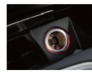
2. Вставте кабель живлення в автомобільний прикурювач (12V)/ Plug the power cable into a vehicle 12V cigarette lighter
