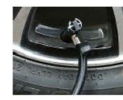
3. З'єднайте ніпель з клапаном шини / Insert the inflatable nozzle on the tire air valve
