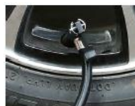
4. З'єднайте ніпель із клапаном шини / Insert the inflatable nozzle on the tire air valve
